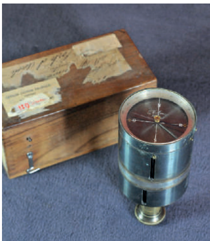
Squadro agrimensorio, 1886-1888 Metallo, Dim.: diam 75; h: 200 mm, Costruttore ignoto Agenzia delle Entrate
